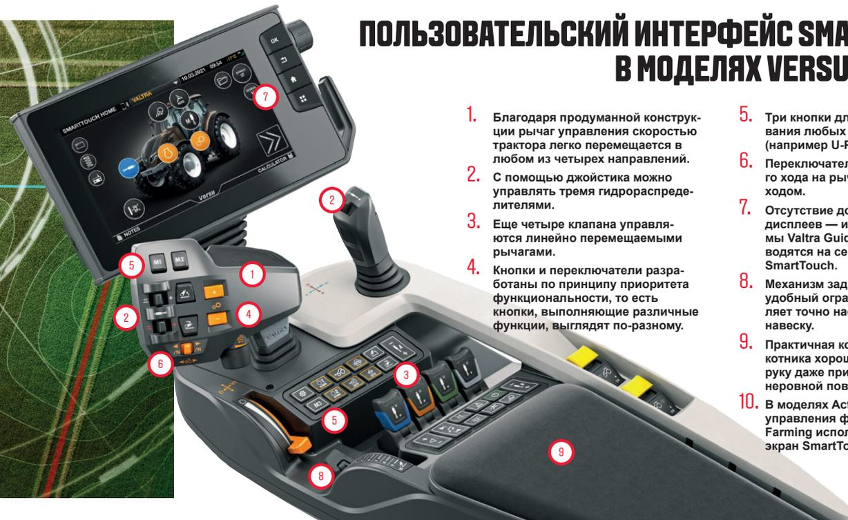
1. Благодаря продуманной конструкции рычаг управления скоростью трактора легко перемещается в любом из четырех направлений.
