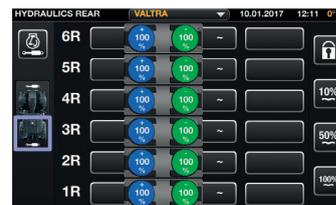
Любой гидравлический клапан можно назначить для любой функции и наоборот. Вы можете управлять любым передним или задним клапаном, включая фронтальный погрузчик и сцепные устройства.
