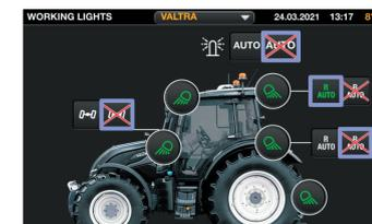
Легко настраивайте рабочий свет с помощью 9-дюймового сенсорного экрана. Рабочий свет уровня Premium и Premium+ также включает устанавливаемые выразные фары, управляемые датчиком угла поворота рулевого колеса на переднем мосту.
