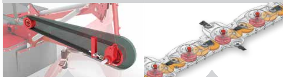
Долговечный режущий аппарат с шестернями, вращающимися в масляной ванне
