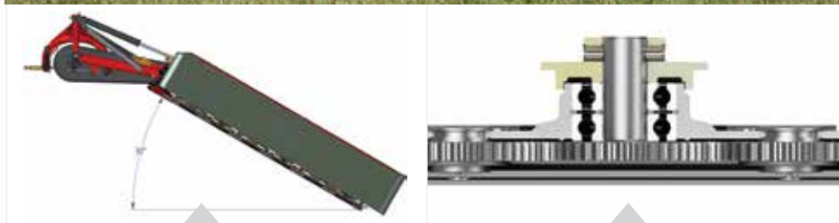
Подвешивание сбоку: возможность работы на наклонных поверхностях
