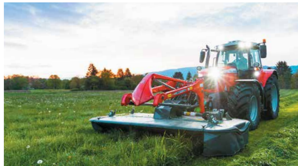
Низкопрофильный режущий аппарат с низкопрофильной зубчатой цилиндрической шестерней
