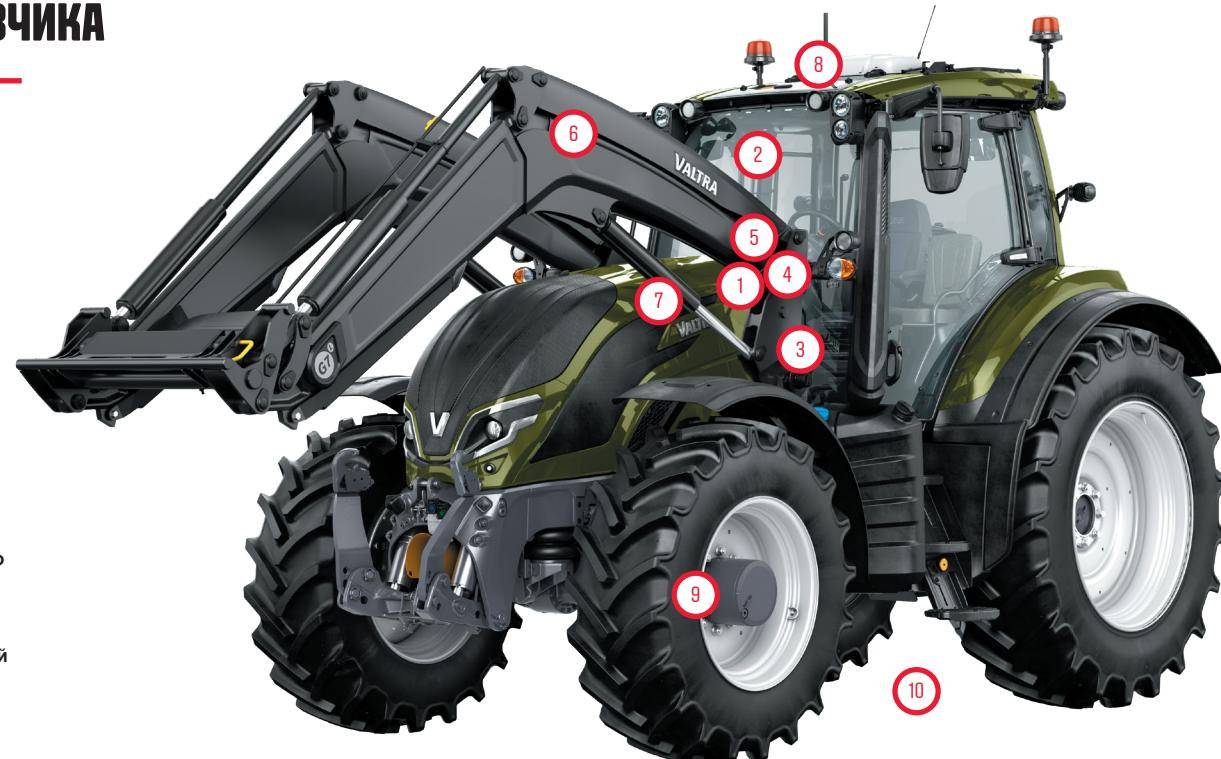
для задних гидрораспределителей предусмотрено механическое управление, а для передних, предназначенных для фронтального погрузчика или подъемника – электронное управление с помощью джойстика на подлокотнике и простых настроек на дисплее, расположеннном на передней стойке.
