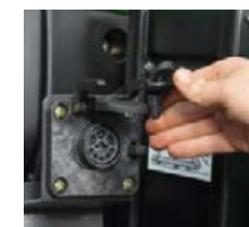
□ Разъем ISOBUS для подключения цепей управления навесным оборудованием.
