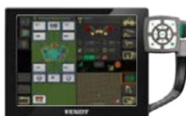
В ночном режиме яркость дисплея регулируется, чтобы поддерживать его подсветку на приятном для оператора уровне. Благодаря меняющемуся дисплею настройки и значки лучше видны.
