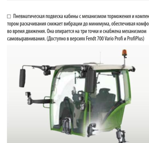
□ Пневматическая подвеска кабины с механизмом торможения и компенсатором раскачивания снижает вибрации до минимума, обеспечивая комфорт во время движения. Она опирается на три точки и снабжена механизмом самовыравнивания. (Доступно в версиях Fendt 700 Vario Profi и ProfiPlus)
