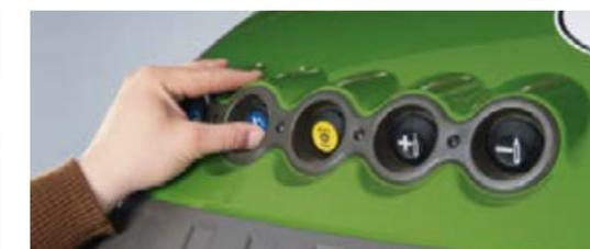
□ С помощью внешних органов управления клапанами, вы можете привести в действие механизм задней сцепки, один клапан и вал отбора мощности непосредственно на заднем крыле. При использовании внешних органов управления задним механизмом отбора мощности, предустановленные обороты двигателя могут устанавливаться автоматически.
