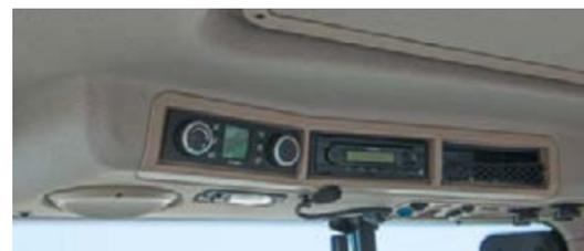
Высокое качество звука при телефонных переговорах без использования рук обеспечивается благодаря подвижному микрофону, установленному на гибком креплении.
