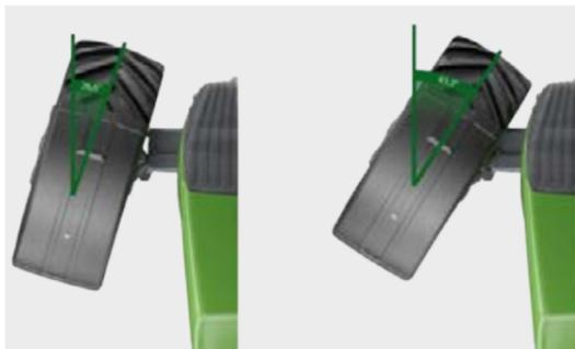
По сравнению со стандартной настройкой использование VarioActive требует на 60% меньше оборотов рулевого колеса для изменения положения колес на тот же угол. VarioActive обеспечивает более быструю реакцию рулевого управления во время крутых разворотов на поворотной полосе. По соображениям безопасности, рекомендуется использовать данный режим при скоростях 0 - 25 км/ч.
