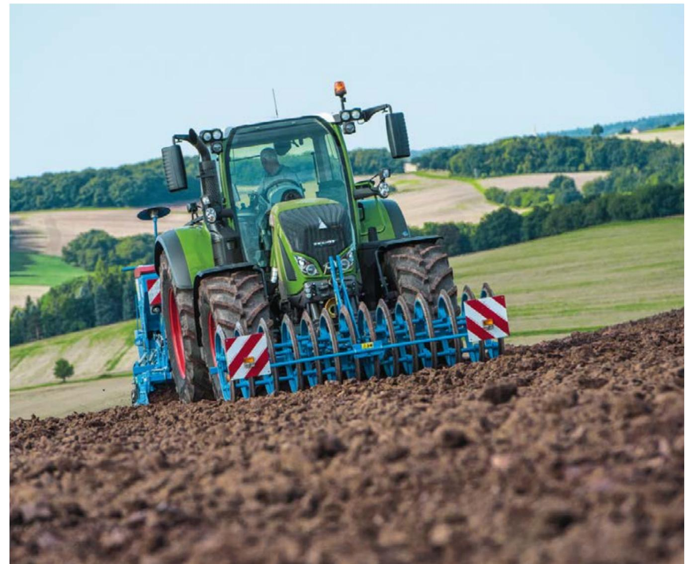
Несущая система трактора Fendt 700 Vario выполнена в виде прочной литой полурамы, допустимая полная масса составляет 14 тонн. Благодаря высокой полезной грузоподъемности 6 200 кг компактный и мощный трактор обладает большими резервами для работы с тяжелым навесным оборудованием.
