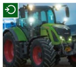
□ Световые потоки рабочих фар оптимально перекрываются. Это позволяет исключить образование теней и отражений, которые мешают оператору хорошо видеть объекты.
