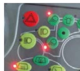
■ Благодаря простой компоновке система освещения легко настраивается и регулируется. С помощью системы управления с помощью одной кнопки все ранее настроенные рабочие фонари можно быстро и легко включить одним нажатием кнопки на мембранной клавиатуре.
