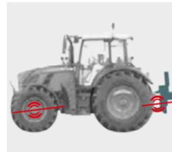
■ Передний мост с системой подвески, которая предлагается даже в базовой комплектации, увеличивает полезную нагрузку и повышает комфорт движения. Ход подвески в пределах +/- 50 мм отлично поглощает неровности поверхности. Угол поворота +/- 8° определяет устойчивость при движении. Угол поворота управляемых колес переднего моста 52° гарантирует максимальную маневренность.
