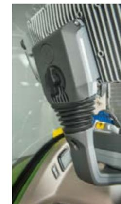
Положение Varioterminal может быть оптимально отрегулировано благодаря новому кронштейну с шаровым шарниром.
