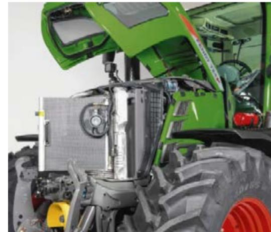
Меньше усилий, больше свободного времени: легкий доступ к компактному узлу охлаждения обеспечивает быструю и простую очистку, благодаря большому зазору между радиаторами и плоским основанием.
