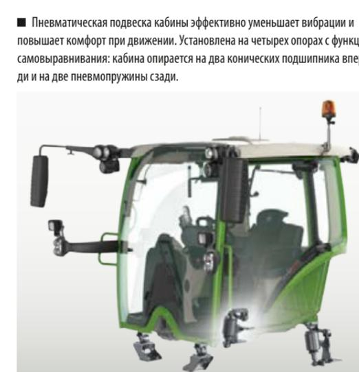
■ Пневматическая подвеска кабины эффективно уменьшает вибрации и повышает комфорт при движении. Установлена на четырех опорах с функцией самовыравнивания: кабина опирается на два конических подшипника впереди и на две пневмопружины сзади.
