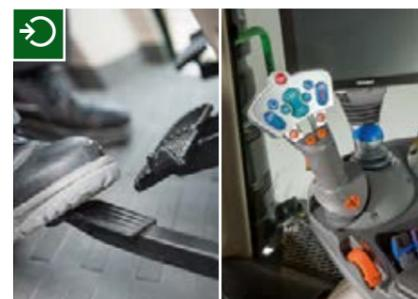
Направление движения может быть изменено с помощью джойстика или рычага реверса на рулевой колонке. Особенно практично: интегрированная функция оптимального стартстопного режима "Stop-and-Go".
