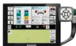
Fendt VarioGuide может поддерживать точность движения в двух режимах: +/- 20 см (VarioGuide Standard) или +/- 2 см (VarioGuide RTK). Впервые вам стал доступен гибкий выбор приемников и сервисов коррекции местоположения.
