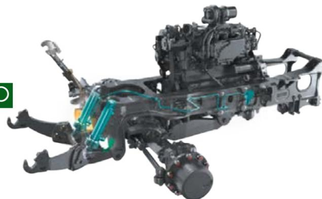
Механизм сцепки настраивается через Varioterminal и приводится в действие модулем управления подъемной тягой, многофункциональным джойстиком или внешними органами управления, расположенными спереди или на заднем крыле.
